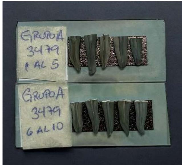
Fig. 4. Muestras preparadas con recubrimiento de oro.
