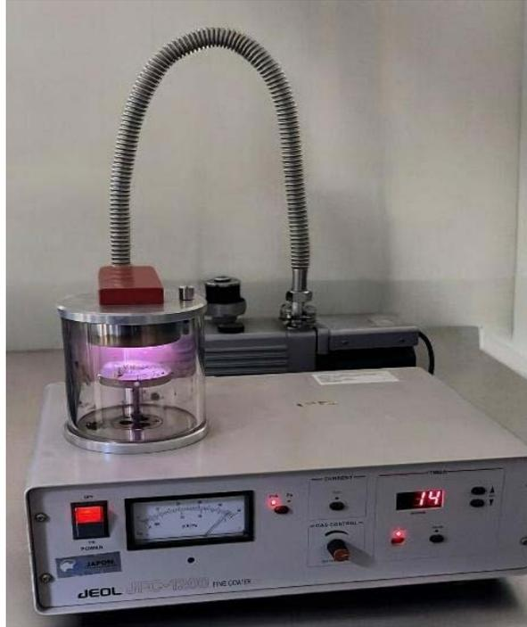
Fig. 3. Recubridor de muestras (JEOL JF-12000).
